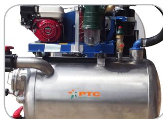
Réservoir en acier inoxydable avec soupape de décharge et soupape de sécurité.
