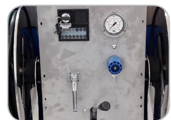
Versions avec système d'impulsions idéal pour débloquer le flexible dans les canalisations
