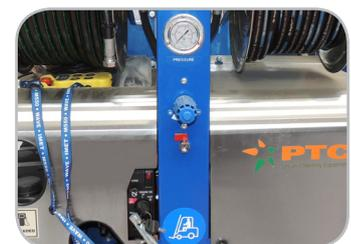
Tableau de commande moteur complet, indicateur de pression et vanne de réglage.
