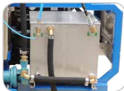
Le grand **réservoir** en acier inoxydable intégré dans la machine compense les variations de pression dans les conduites d'eau, évite les bulles d'air dans le circuit d'eau et offre une bonne autonomie à l'appareil.
