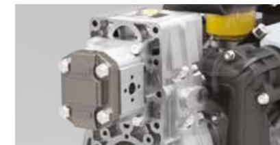
Boîte surmultipliée pour la pompe hydraulique du côté aspiration utilisant un support spécial
