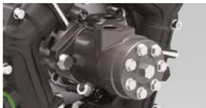
Moteur hydraulique côté refoulement, directement flasqué, utilisant un support spécial
